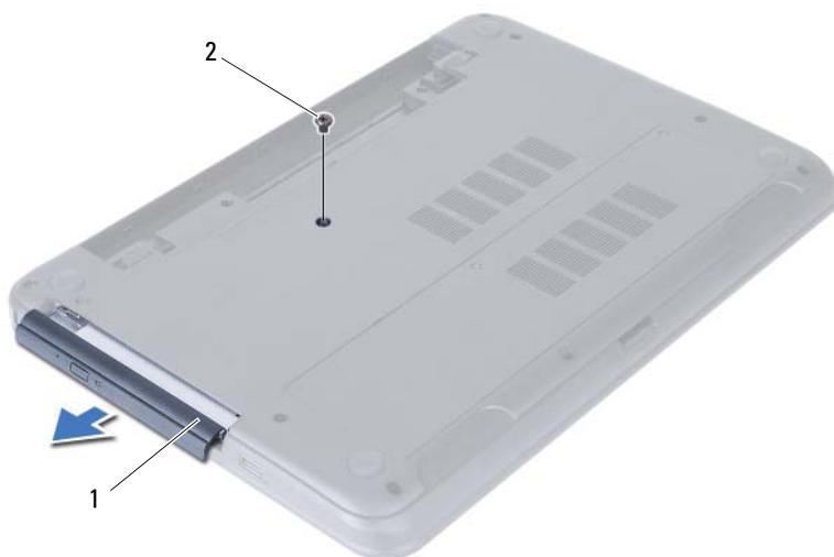
1 sklop optičke disk jedinice
